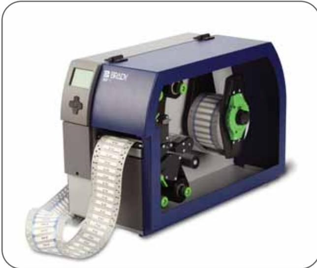
Der BBP™72 von Brady ist ein 4 Zoll-Thermotransferdrucker für das doppelseitige Bedrucken von Schrumpfschläuchen. Dieser Drucker arbeitet besonders schnell, da er beide Seiten des Schrumpfschlauchs gleichzeitig bedruckt. Er ist die ideale Lösung in der Raum- und Luftfahrt, Verteidigung sowie im Nah- und Fernverkehr.
