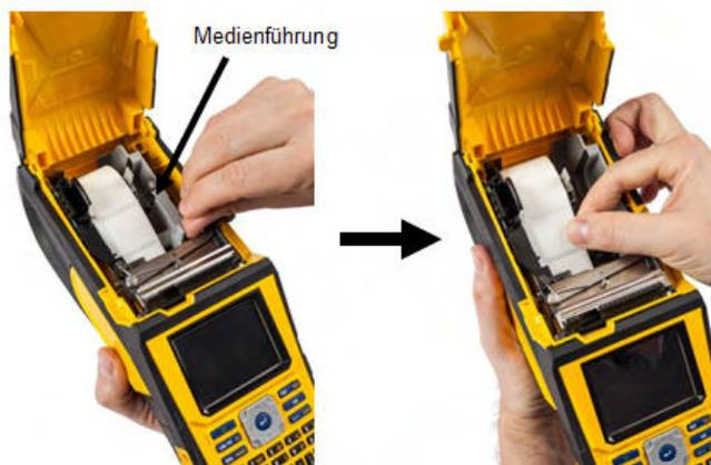
5. Bei eingeschaltetem Netzstrom die Vorschubtaste einmal drücken, um die Medien unter dem Druckkopf vorzuschieben.
