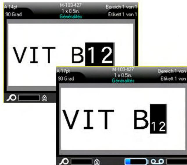
Abbildung 3-3. Anwendung von „Tiefgestellt“ auf mehrere Zeichen
