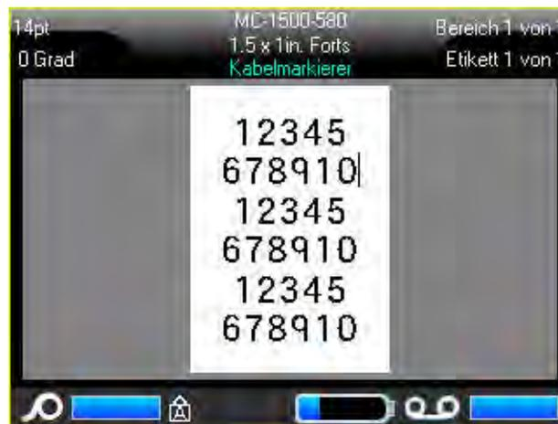
Abbildung 6-3. Drahtmarkiereretikett mit mehreren Zeilen
