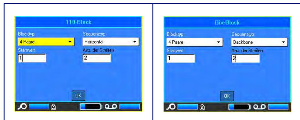
Bei den Anwendungen 110- und BIX-Block hängt die Anzahl der erstellten Bereiche von der gewählten Paarkonfiguration ab. Es werden automatisch vertikale und horizontale Trennlinien hinzugefügt.
