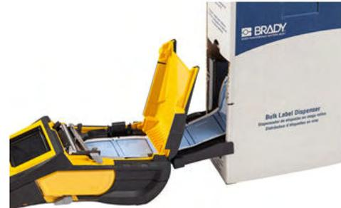
7. Die Führungskante der Medienrolle weiter über die Etikettenspule und durch die Führungsschlitze führen, bis sie einrastet.
