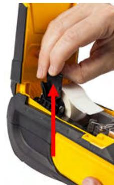
5. Wenn keine Medien mehr eingelegt werden sollen, die Druckerabdeckung schließen, indem Sie auf die Abdeckung drücken, bis sie einrastet.
