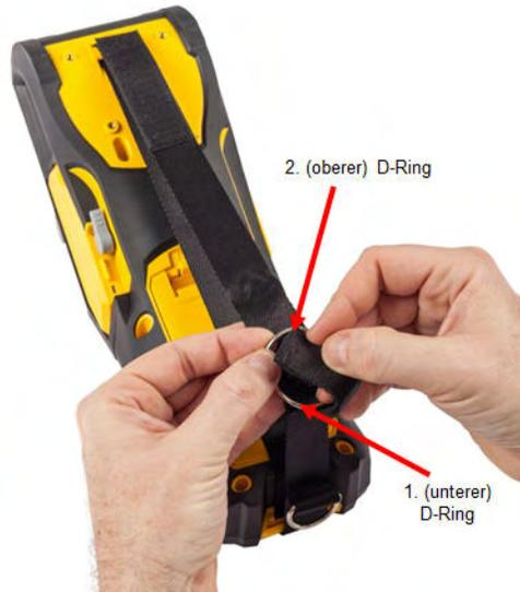
6. Am losen Ende des Gurtes ziehen, bis er sich fest gespannt anfühlt, und den Klettverschluss gegen den Gurt drücken, damit dieser flach liegt.
