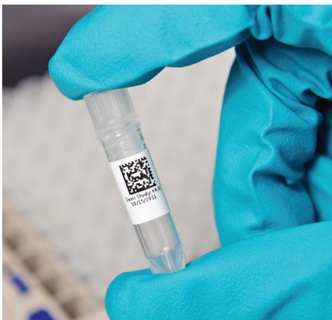
Brady Corporation bietet Etiketten mit Angabe zur Sterilisation an, mit dem Anwender über einen Nachweis der erfolgten Sterilisation verfügen. Diese Etiketten eignen sich ideal für zahlreiche Anwendungen im Labor, wie zum Beispiel die Nachverfolgung von Laborproben, die Bestandsverwaltung, die allgemeine Rückverfolgung sowie die Kennzeichnung von Glasbehältern und Schalen.
