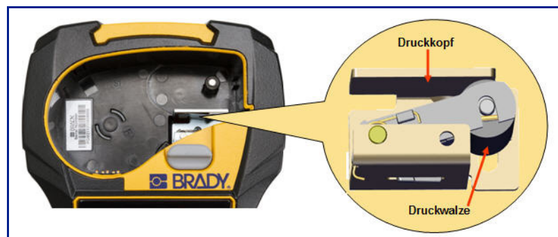
Abbildung 9 • Druckkopf und Druckwalze im Kassettengehäuse.
